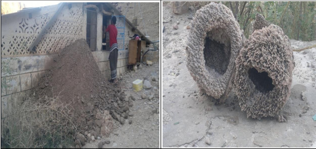
صورة (2) أثر الترسبات الناتجة عن استخدام المياه الجوفية
